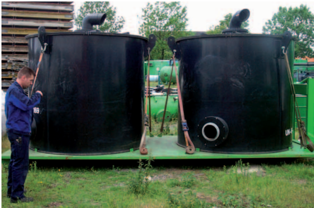
2 LAK 5.000 Aktivkohlefilter montiert auf einer Kakenplatte zum schnellen Einsatz und Austausch
